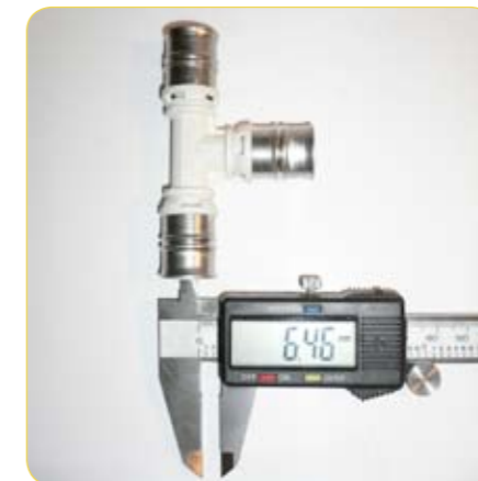
Los accesorios utilizados corresponden al tubo de cobre de 15x1 mm y su equivalente en multicapa 16 x 2 mm
